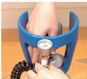
STEP5 新しいボンベに圧力調整器を取り 付ける。プロテクター（青色）の 持ち手部分から圧力調整器が出る ように取り付ける。
