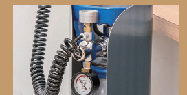
STEP5 新しいボンベに圧力調整器を取り 付ける。プロテクター（青色）の 持ち手部分から圧力調整器が出る ように取り付ける。
