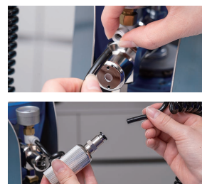
STEP3 プラスチックリングを押しながら ガス充填ホースを抜く。
