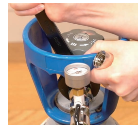
STEP6 専用スパナで圧力調整器の 袋ナット部分を締める。
